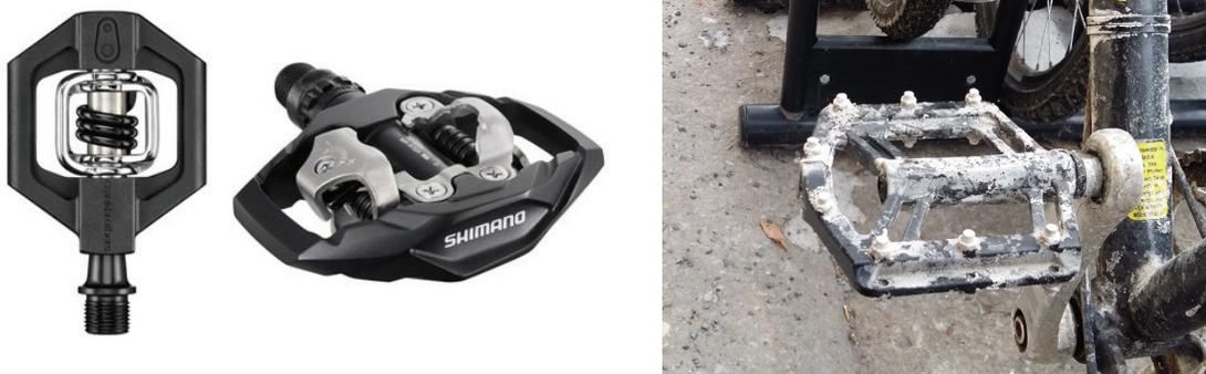
Figure 4 - Pédales à clip et pédale antidérapante
