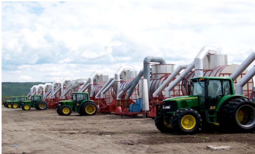
Figure 7 – ASPIRATEURS GÉANTS SERVANT À LA RÉCOLTE DE TOURBE (Équipements conçus et fabriqués au Québec)
