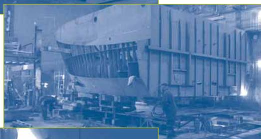
Assemblage des tôles de bordé sur la section avant de la coque.
