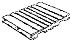
Palette 4 voies ou entrées, flush, avec des planches en dessous. Les planches situées à l'avant et à l'arrière doivent être d'une largeur maximum de 6" et au centre nous devons retrouver un minimum de 1 et un maximum de 3 planches d'une largeur minimum de 2".
