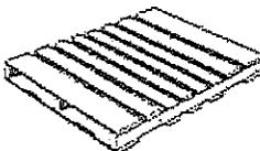
Palette 2 voies ou entrées, flush, avec des planches en dessous. Les planches situées à l'avant et à l'arrière doivent être d'une largeur maximum de 6" et au centre nous devons retrouver un minimum de 1 et un maximum de 3 planches d'une largeur minimum de 2".
