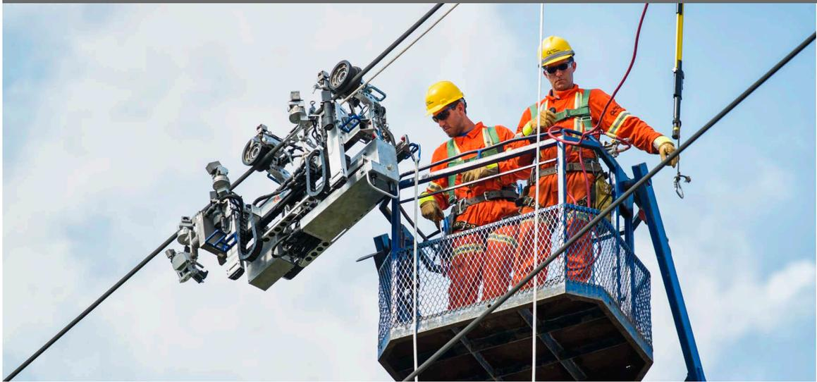
1 En vertu d'une licence pour le Royaume-Uni, la société britannique National Grid pourra exploiter pendant dix ans le LineScout, un robot télécommandé conçu par l'IREQ pour l'inspection des lignes de transport à haute tension.
