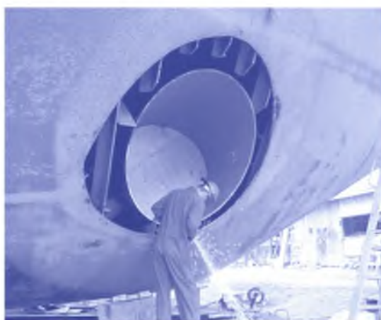
Installation d'un propulseur d'étrave sur le N.M. Lomer-Gouin pour faciliter les manœuvres d'accostage du navire
