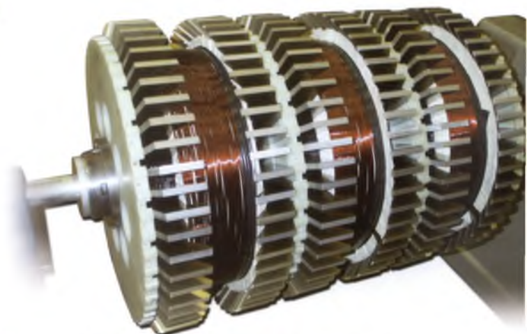
Alternateur basse révolution à aimants permanents et flux magnétique transverse. Eocycle Technologies Inc., Gaspé
