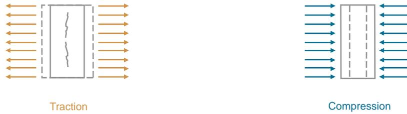
Figure 2.11 Illustration des contraintes de traction et de compression
