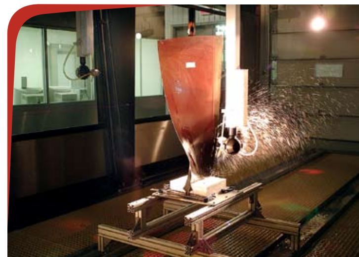
Le Centre international de contrôle non destructif de l'Institut de recherche sur l'hydrogène dispose d'un scanner permettant la détection par ondes ultrasoniques de défauts dans la structure de pièces de grandes dimensions. Cette image illustre bien les recherches en cours à l'IRH. Photo : service des communications de l'Université du Québec à Trois-Rivières
