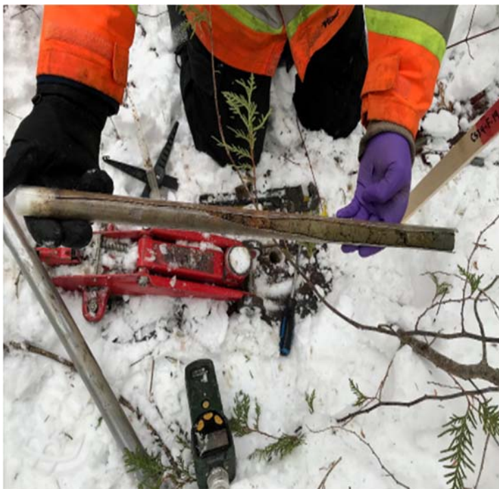
Géoprobe manuelle, Golder 2019
