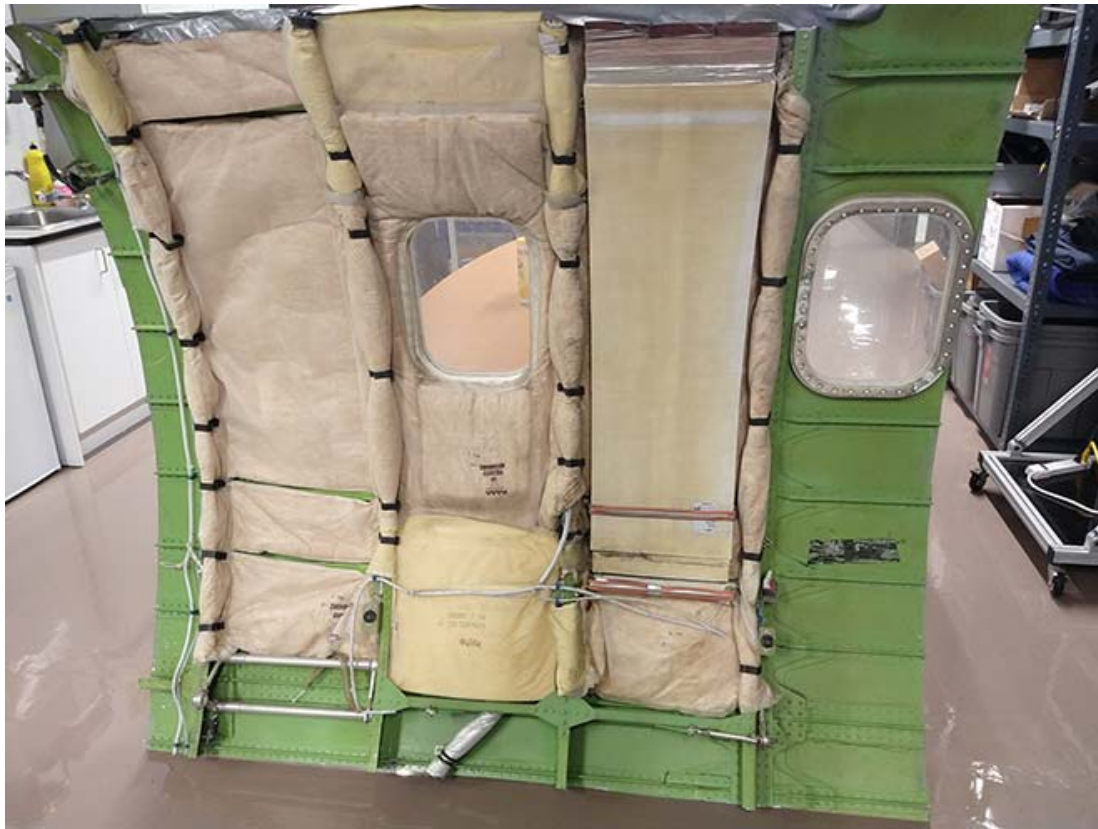
Portion de structure de fuselage d'avion avec isolant acoustique apparent.
