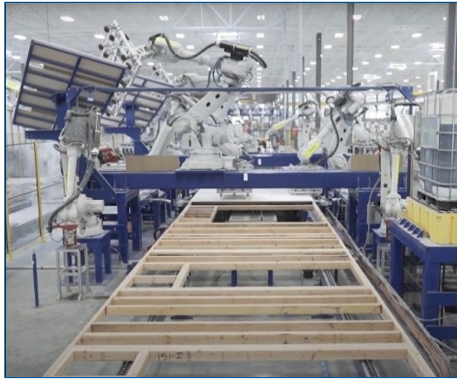
Production automatisée. ©Autovol
