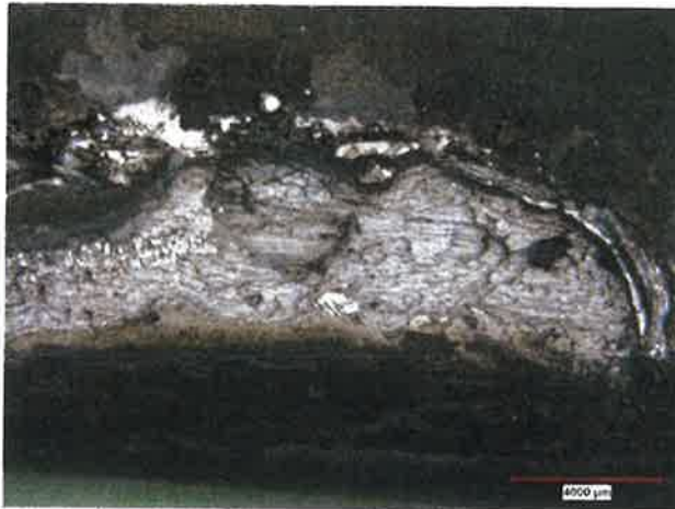
Figure 28 — Microscopie du faciès de rupture de la soudure de la colonne de soutien qui présente un profil d'arrachement lamellaire
