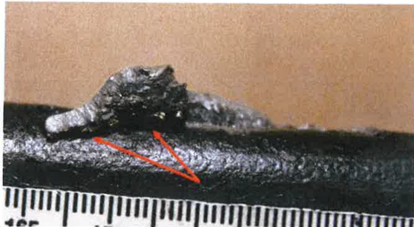
Figure 14 – Partie en tension, exemple de concentrateurs de contraintes (flèches rouges)
