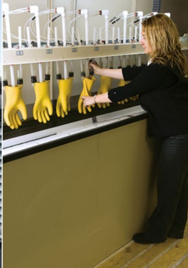
Sylvie Mongrain, chef préposée – Laboratoire, vérifie la qualité des gants isolants que les jointeurs doivent porter lorsqu'ils réalisent des travaux sous tension.
