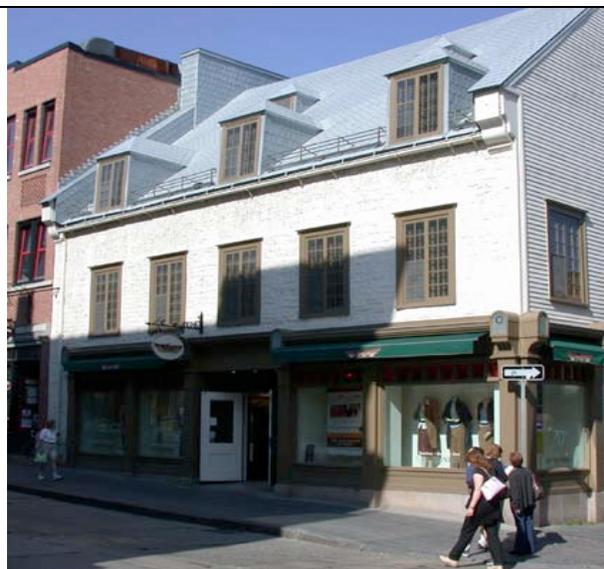
Façade commerciale rue Saint-Jean. Bien que la paroi ait été remplacée par une structure squelettique, la charpente est compréhensible et les interaxes sont cohérents avec ceux de l'étage
