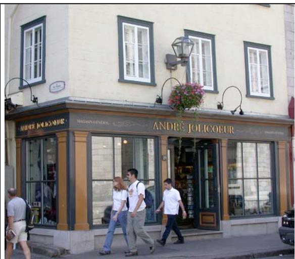
Façade commerciale rue Buade : la charpente de type poutres et colonnes est fortement exprimée et la structure du bâtiment est parfaitement intelligible.
