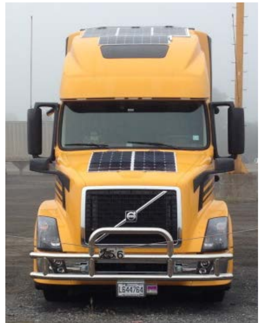
Panneaux solaires sur camions lourds
